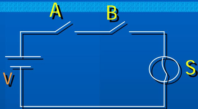
$\left\{ \begin{array}{l} A, B = 0 \rightarrow \text{chave aberta} \\ \quad \quad 1 \rightarrow \text{chave fechada} \\ S = 0 \rightarrow \text{luz apagada} \\ \quad \quad 1 \rightarrow \text{luz acesa} \end{array} \right.$
