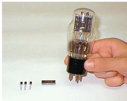
Figura 12. Transistores, integrados e válvulas
